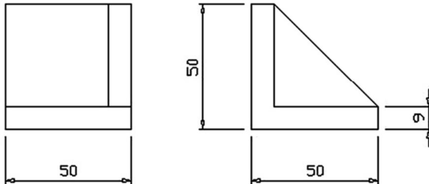
Stabiler Winkel, gut geeignet als Eckverbinder für größere Gestelle oder als Halterung für schwere Anbauteile, Zylinder usw.
