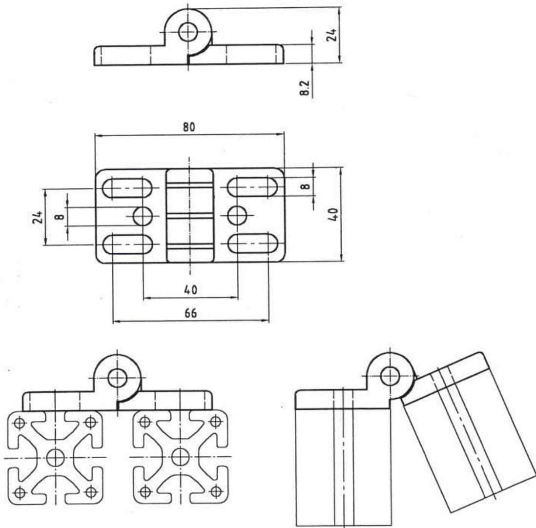
Scharnier für höhere Belastung einsetzbar. Die Befestigung kann entweder an den Profilaußenflächen (über die Langlöcher) oder an den Profilstirnseiten (über die Bohrungen mit  $\varnothing 8$ ) erfolgen.
