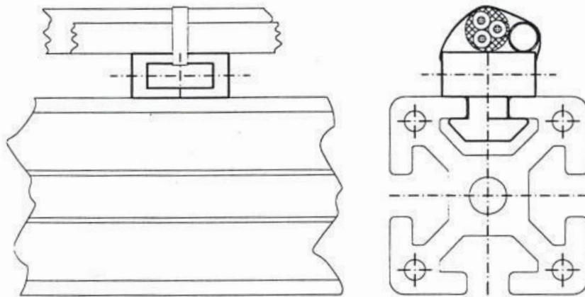
Kabelbinderblock zur Befestigung von Kabeln und Schläuchen mit Kabelbindern an Konstruktionsprofile mit Nut 8. Durch Eindrehen in die Profilnut ist ein nachträgliches Einsetzen möglich.
